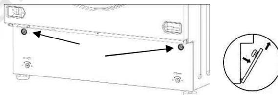
Отдельно стоящая модель - Вставьте маленькую отвертку в прорези в передней дверце плинтуса, затем слегка подденьте отверткой вверх, чтобы освободить верхнюю часть плинтуса корпуса. Слегка наклоните вперед плинтус и потяните его вверх, чтобы полностью снять.
